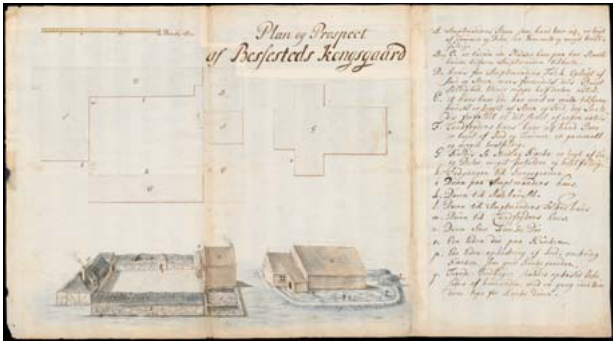
Mynd 5. Á teikningunni Plan og prospect af Bessstedts kongsgaard eru bæjarhúsin á Bessastöðum teiknuð frá hlið og í fleti, eins og þau munu hafa litið út árið 1720. Til hægri eru skýringar á einstökum byggingarhlutum (ÞÍ. Teikn. 6/1. Bessastaðir um 1720. Ljós. Þjóðskjalasafn Íslands).
