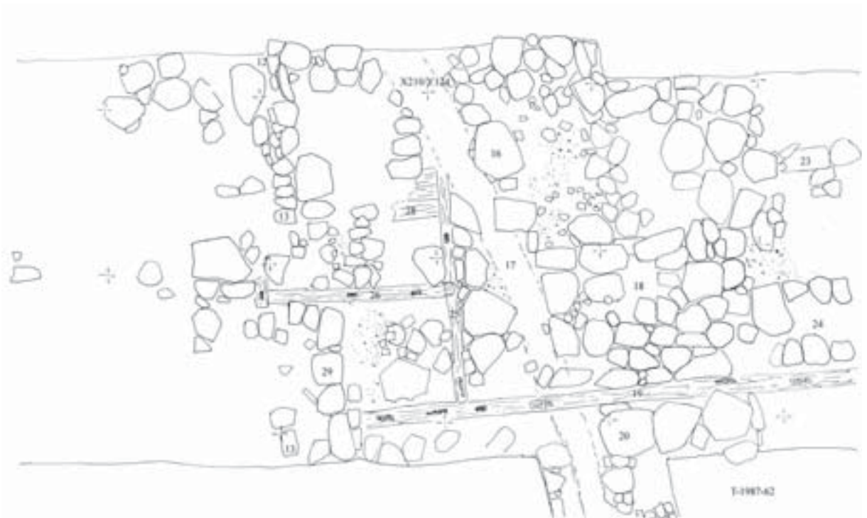
Mynd 47. Viðarleifar sem tilheyra 18. aldar bindingsverkshúsi, framan við Bessastaðastofu. M.a. má sjá fótstykki, gólfbita og gólfborð. Sums staðar má sjá úrtök í fótstykkinn, sem tappar veggjastoðanna gengu ofan í (T-1987-62, G.O. teiknaði eftir ljósmynd).
